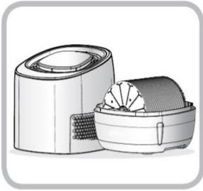
entfernen Sie es oberer Teil von das Gerät und beiseite stellen.
