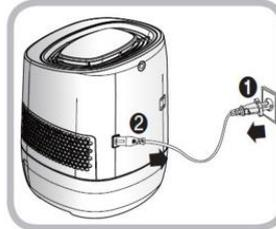
Wenn Sie das Netzkabel abziehen, ziehen Sie zuerst das Netzkabel ab und ziehen Sie dann den Stecker vom Produkt ab.
