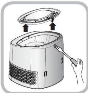
entfernen Sie es Oberteil des Geräts und beiseite stellen.
