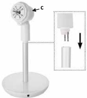
3. Fissare la testa del ventilatore sull'unità motore.
