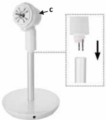
3. Fastgør ventilatorhovedet på motorenheten.
