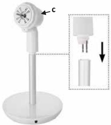
3. Acople el cabezal del ventilador a la unidad de motor.
