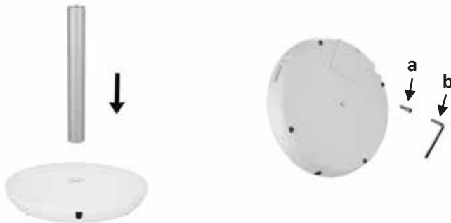
2. Bringen Sie die Motoreinheit [c] oben am Standrohr an.
